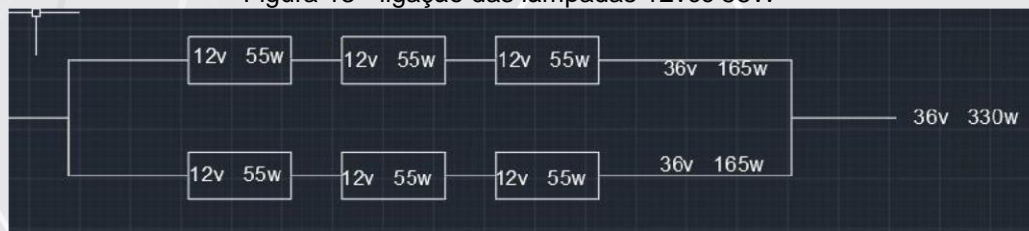
Figura 13 - ligação das lâmpadas 12vcc 55W
