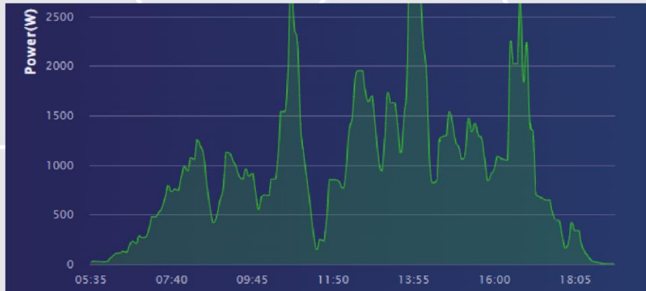
Gráfico 2 - Gráfico de potência de um sistema fotovoltaico em dia com incidência de sombras
