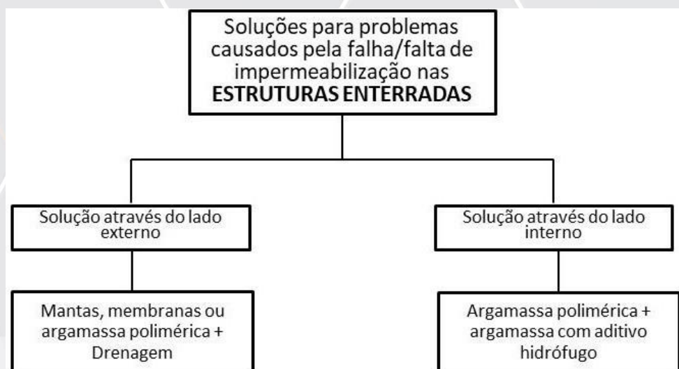
Figura 15 – Esquema de soluções para problemas causados pela falha/ falta de impermeabilizantes nas estruturas enterradas.
