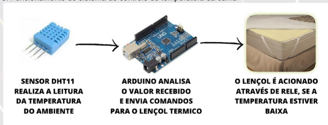
Figura 9: Funcionamento do sistema de controle de temperatura da cama
