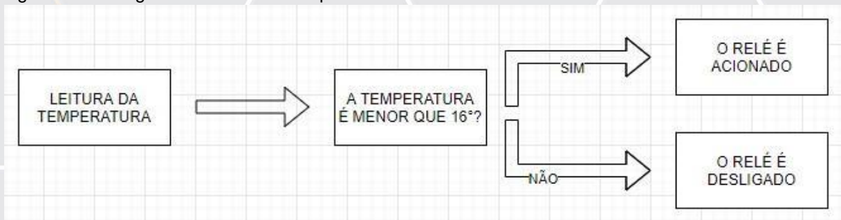
Figura 10: Fluxograma controle de temperatura
